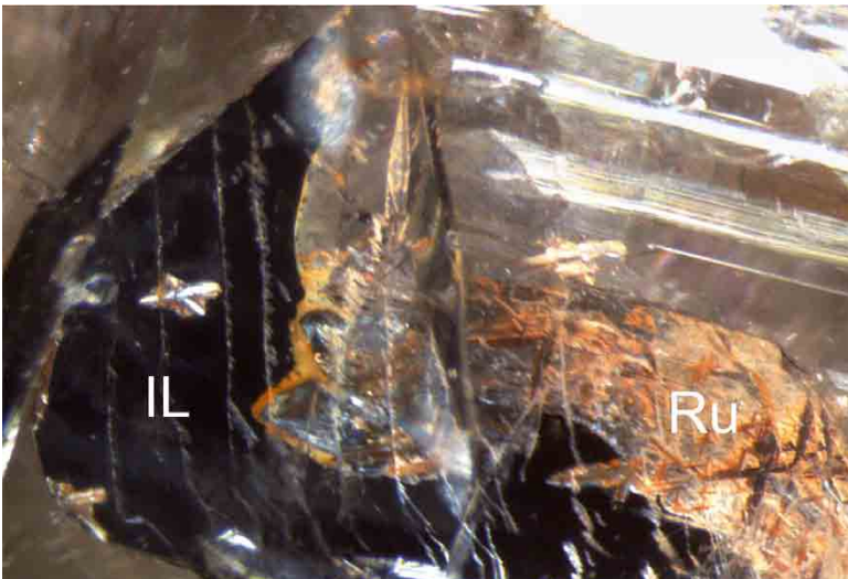
Abb. 19: Reliktsch erhaltener Ilmenit (IL) mit Umwandlung zu Sagenitförmigem Rutil (Ru) in Quarz, Aderwand, Dorfertal bei Kals, Osttirol; Bildbreite 2 cm.
